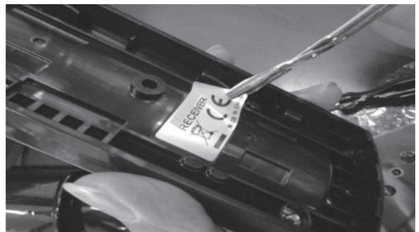
写真5 電子機器の仕向け地別ラベル貼り付け
